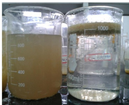
压裂返排液处理
