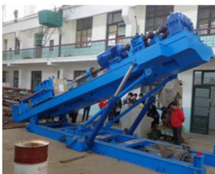
旋转导向钻进动态试验台 (300万)
