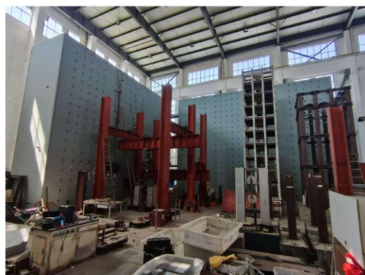
四通道电液伺服加载试验系统
