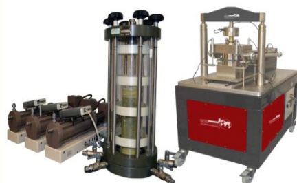
细-粗粒土直剪实验
